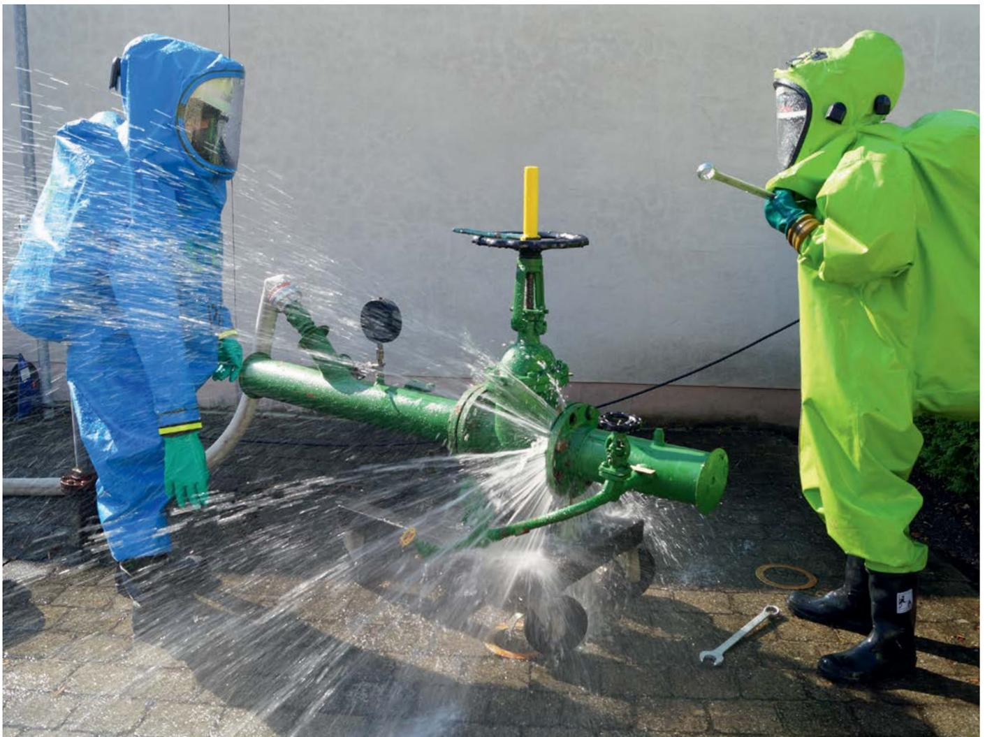
Abdichten eines lecken Rohrsystems unter CSA
